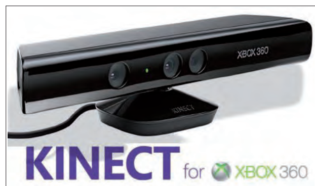
Kinect , de Microsoft, tiene 2 sensores 3D ("ojos" de visión estereoscópica), una cámara de vídeo y una serie de micrófonos direccionales a todo lo largo. Es capaz de interpretar el lenguaje de signos y reconocer órdenes mediante gestos.
